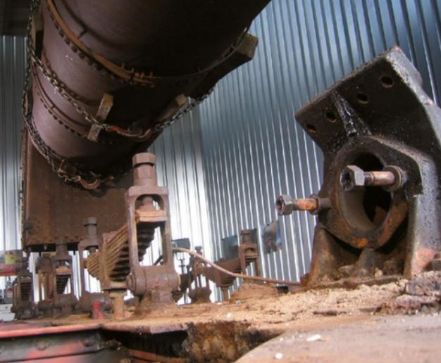
Der Kessel wird abgehoben, damit der Zugang zu den Achslagern von innen frei wird.
