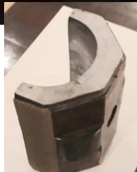
Achslagerschale (eingebaut wird das Lager um 180 Grad gedreht)
